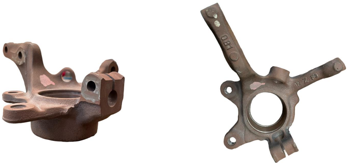
Figure 1: Porte fusée de voiture
