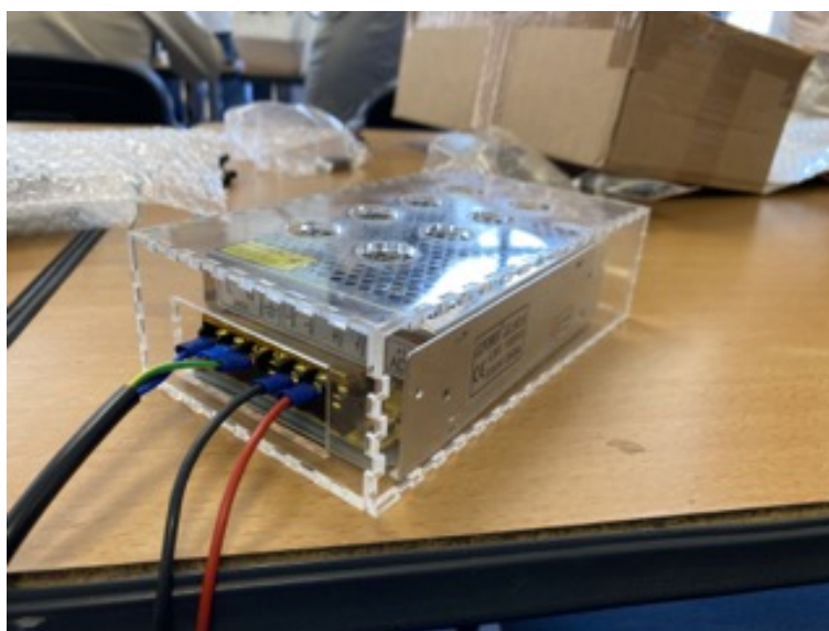
FIGURE 12 – Alimentation avec sa protection
