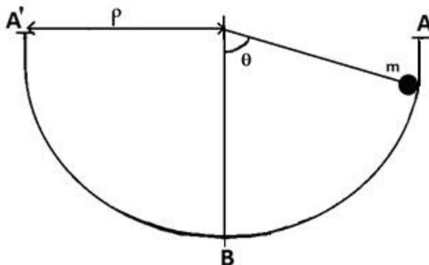
Un objet ponctuel  $M$ , de masse  $m$ , est lâché sans vitesse initiale d'un point A, au sommet d'un guide hémisphérique de rayon  $\rho$ . A l'instant  $t$ , on note  $R$ , la réaction du guide hémisphérique et la position de  $M$  est repérée par l'angle  $\theta$  avec la verticale passant par B (**Figure 2**).
