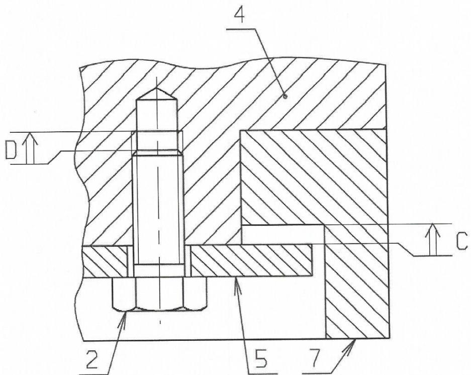
5 - Tracer « proprement » les chaînes de cotes relatives aux vecteurs cotes-condition C et D.
